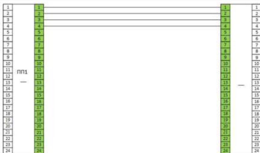
Рис. 1. Схема распределения кабелей резервной горизонтальной подсистемы
